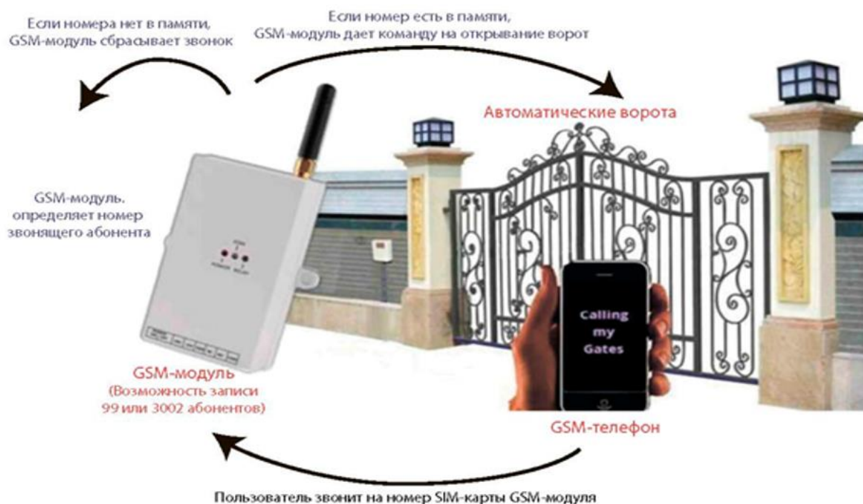
6.3-Сурет. GSM телефонымен қақпаны ашу/жабу қызметін басқаратын жүйенің жалпы сыртқы көрінісі
