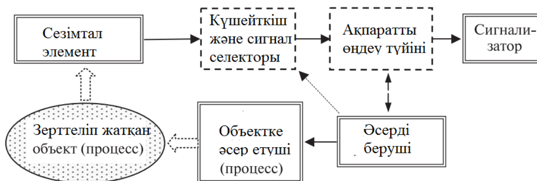
1.2-сурет. Актив сенсордың функционалдық сызбасы
